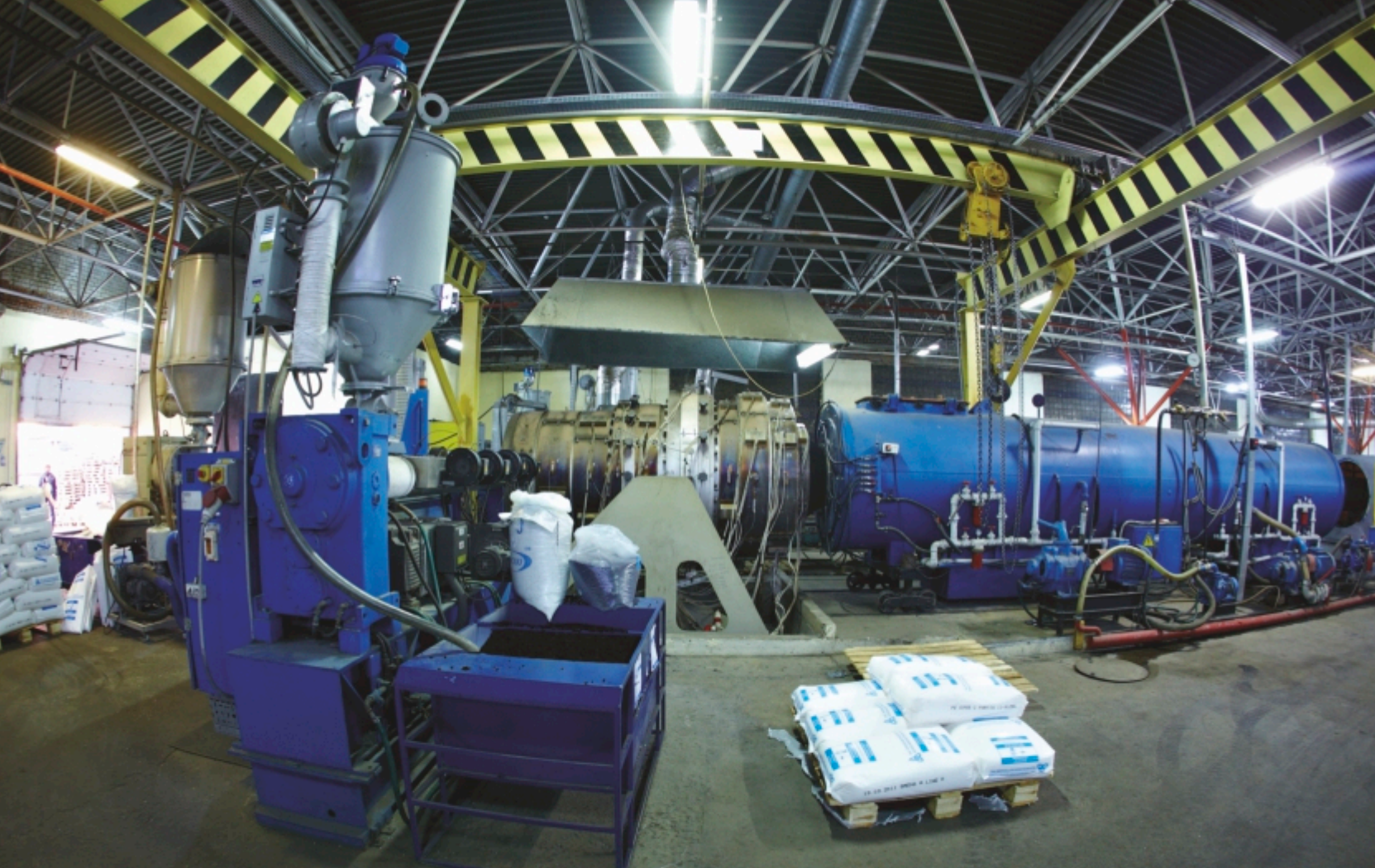
ЛИНИЯ ПО ПРОИЗВОДСТВУ ПОЛИЭТИЛЕНОВОЙ ОБОЛОЧКИ
